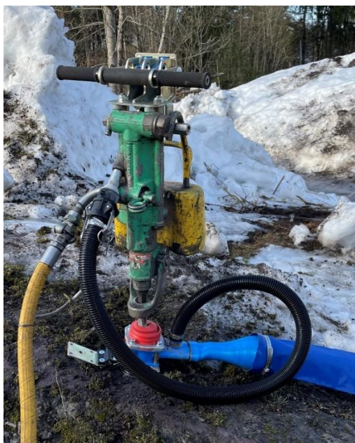
Bilde: Støvsuger montert på en Montabert T18 borhammer satt opp for vertikalboring
